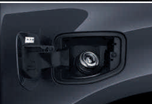
Système de remplissage sans bouchon Ford Easy Fuel
